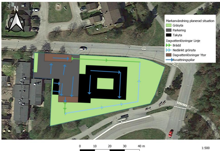
Figur 15 – Skiss över föreslagna dagvattenlösningar och deras funktion.
