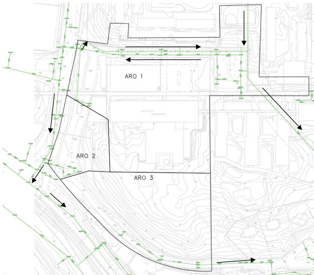
Figur 6. Dagvattenledningar och befintlig avvattnings inom och omkring planområdet. Svarta pilar visar flödesriktningen i ledningsnätet.
