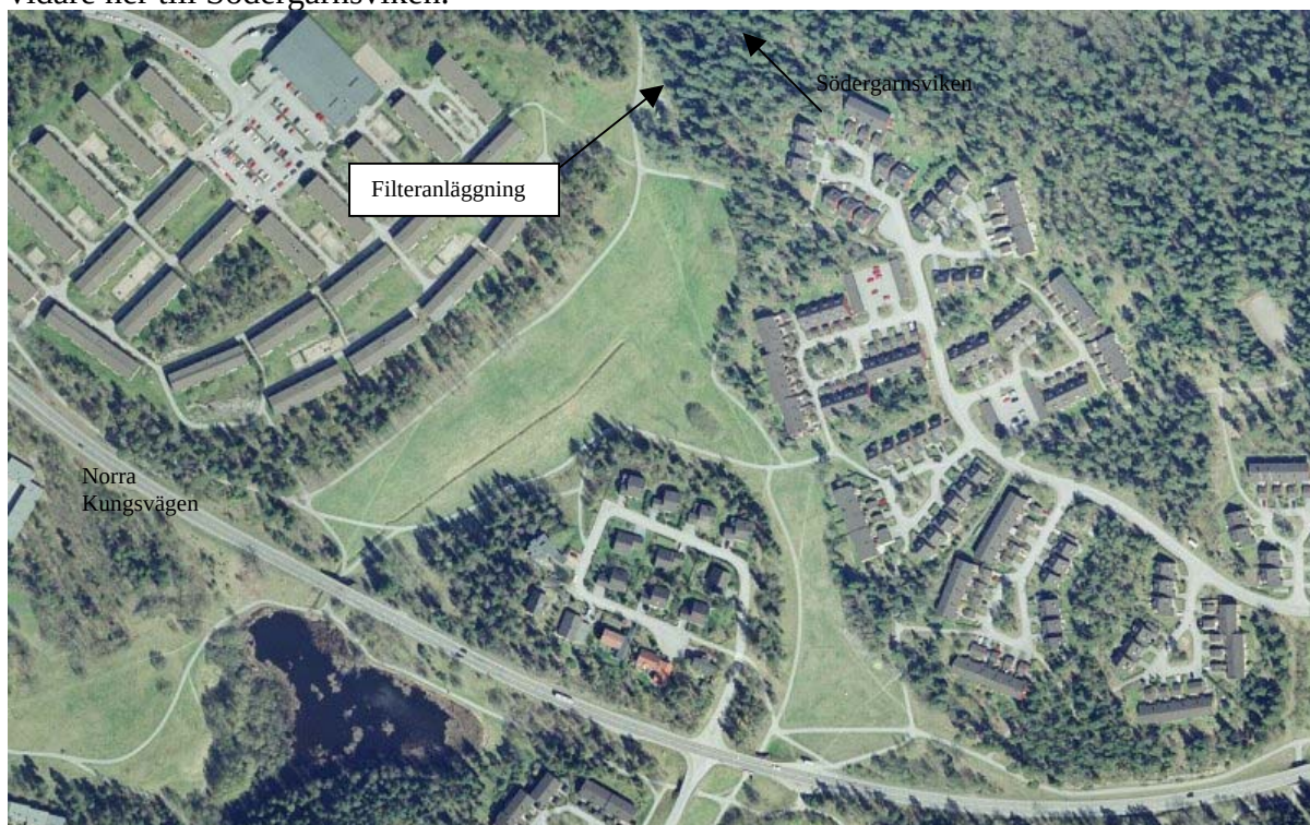
Figur 12. Dagvattnet leds till skogsparti där det släpps och ringlar likt en skogsbäck ner till Södergarnsviken.
