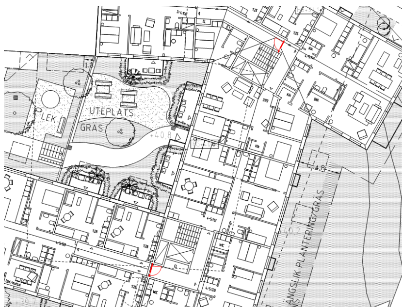
Figur 3, Exempel på placering av dörrpartier i normalplan.
