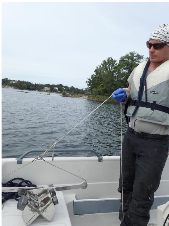
Figur 3. Med hjälp av en van Veen-huggare togs sedimentprov som sållades genom 1 mm maskstorlek för analys av bottenfauna.
